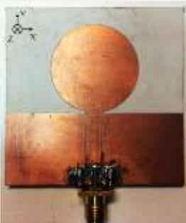
Опытный образец СШП антенны
